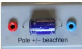
Kondensator, speichert elektrische Ladung
